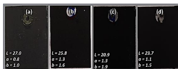
Figure 1: Macroscopic image of PEO-treated specimens: (a) PEO-2 min, (b) PEO-3 min, (c) PEO-4 min, (d) PEO-5 min.
